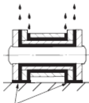
プレートが滑るときは この部分にも給油
